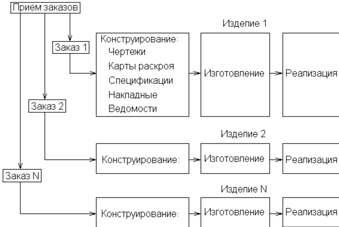
Рис. 6.2. Традиционный процесс автоматизированного проектирования
